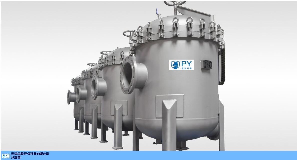
一般情况下大部分企业都会选择不锈钢精密过滤器，主要原因是由于压缩空气具有较大压力，而不锈钢的耐压性好，内部滤芯也较多使用不锈钢丝网；但是如果要做高精度过滤，还需要搭配使用滤芯和折叠式滤芯等高精度的滤芯。一般都能达到 $0.1\mu\text{m}$ 的过滤精度。
