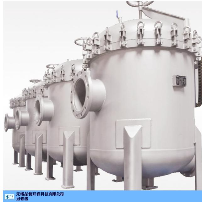
如果不增加保安过滤器经过砂、碳过滤系统处理后的水中的较大颗粒物质会经过高压泵的加压以后不仅会堵塞RO膜也会划伤反渗透膜，会造成反渗透膜的脱盐率降低，甚至会损坏反渗透膜。所以保安过滤器的作用就是使反渗透膜的运行更加安全、可靠、延长RO膜的使用寿命。
