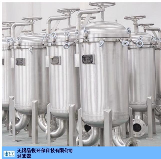
精密过滤器（又称作保安过滤器），筒体外壳一般采用不锈钢材质制造，内部采用PP熔喷、线烧、折叠、钛滤芯、活性炭滤芯等管状滤芯作为过滤元件，根据不同的过滤介质及设计工艺选择不同的过滤元件，以达到出水水质的要求。用于各种悬浮液的固液分离，环境要求比较高的，过滤精度比较高的药液过滤，适用范围广，适用于医药、食品、化工、环保、水处理等工业领域。
